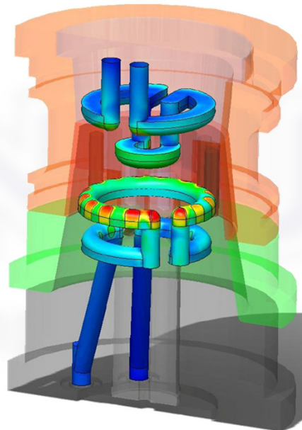
Temperaturverteilung an der Oberfläche des Temperierkanals
